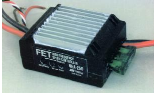
Variateur de vitesse moderne avec dissipateur de chaleur et fusible (vert, à droite).
