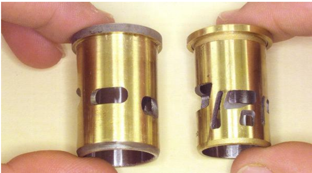
Chemises de deux moteurs à deux temps. Celle de droite, provenant d'une voiture de compétition, présente de nombreuses lumières d'admission destinées à optimiser l'arrivée des gaz frais.
