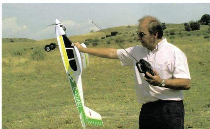
*Lorsqu'on met le modèle nez vers le haut, le mélange tend à s'appauvrir. Le moteur doit pouvoir supporter cette position environ 15 secondes sans s'arrêter. Condition: le gicleur ne doit pas être trop fermé.*
