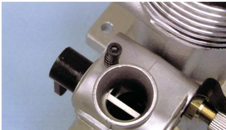
*Carbureteur d'un YS complètement ouvert. Le carburant sort sous pression par l'un des côtés. Spécial, mais très efficace. La régulation de l'air se fait par le biais d'un papillon et non, comme c'est souvent le cas, d'un barillet.*
