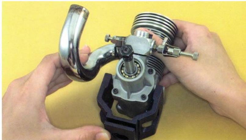
*Sur un résonant, la longueur du coude est déterminante pour un fonctionnement optimal.*
