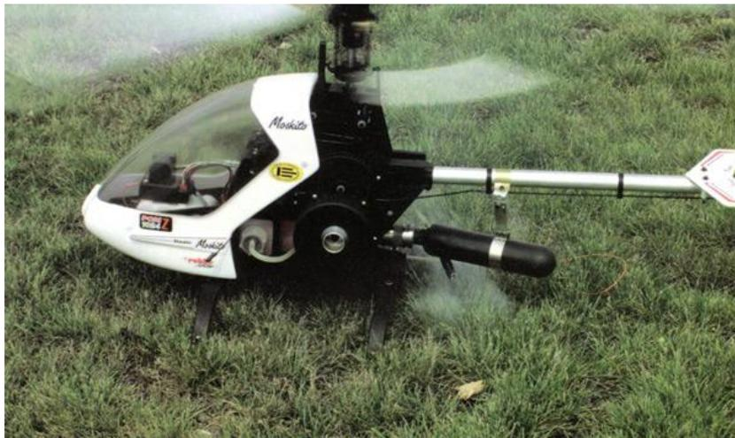
*Il est plus facile d'adapter le régime moteur à celui du résonant sur un hélicoptère que sur un aéromodèle avec hélice à pas fixe.*
