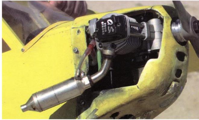
*Les moteurs à quatre temps ne tirent aucun avantage d'un résonateur; ils emploient des systèmes à expansion plus ou moins sophistiqués.*
